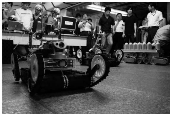
神戸地下街での「被災建造物内探索ロボット」実証実験の様子
