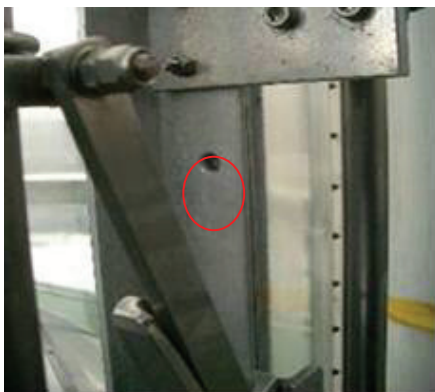
図5. - 6(i) 南京錠施錠用の鍵穴（ライトプログラム中に突然扉が開くのを防止するため）
