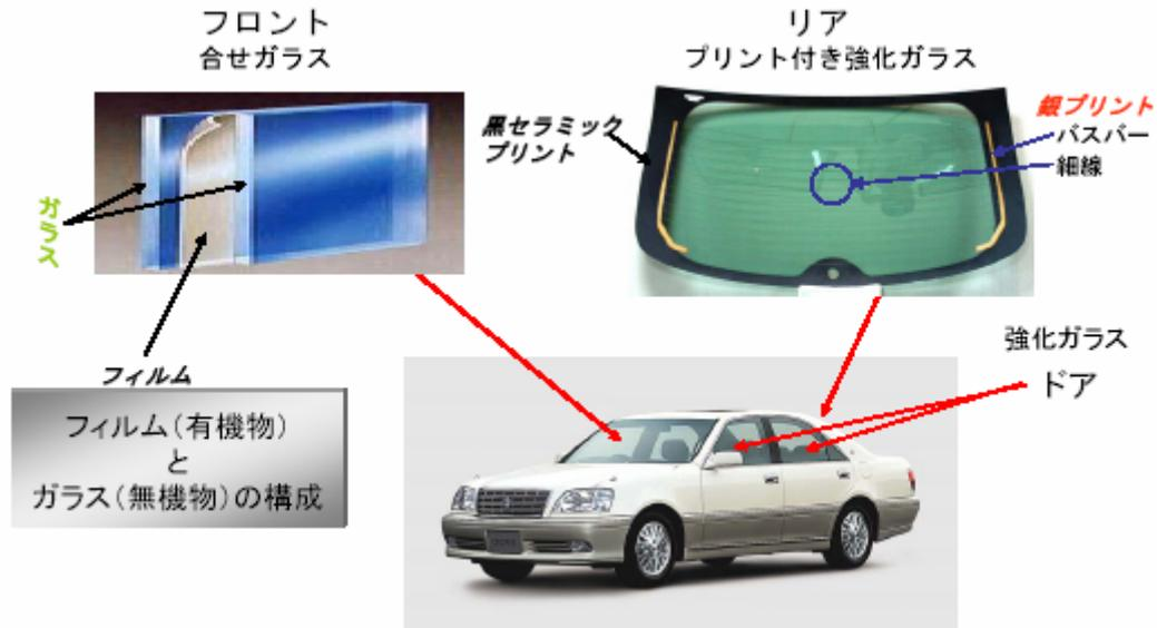
図3. 2. 1. 1 自動車用ガラスの構成（「Glass Recycling Systems Workshop 2006」より抜粋）
