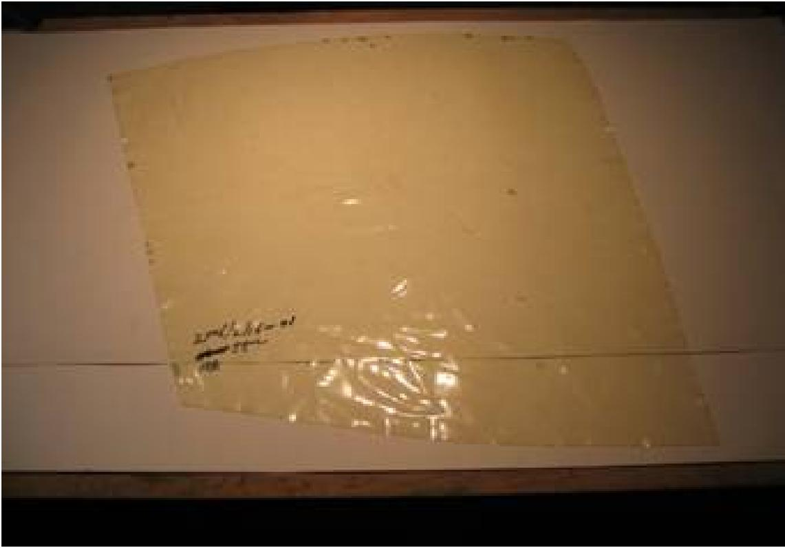
図 3. 3. 2. 6 (写真)バレル装置で分別回収した PVB 中間膜の外観
