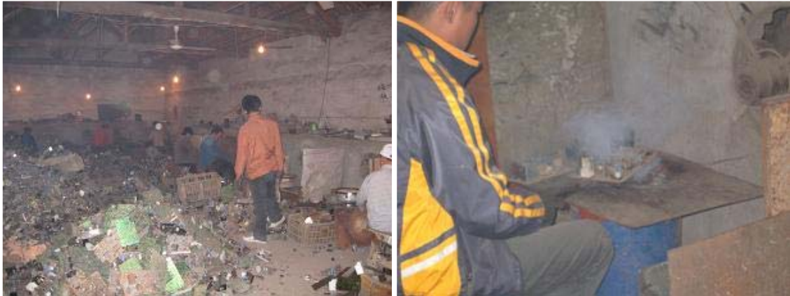
図 2.1.3-15 臨沂の廃基板リサイクル業者における半田の熔融
