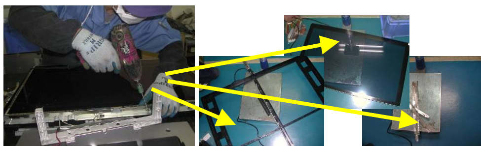
(工程 6) ガラス枠の分解、前面ガラスの取り出し
