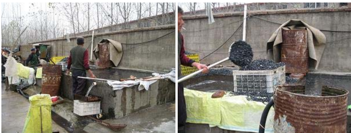
図 2.1.3-13 臨沂の廃テレビリサイクル業者における筐体の破砕・選別
