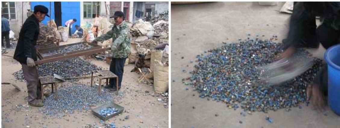
図 2.1.3-16 臨沂の廃基板リサイクル業者における 篩による選別（左）と磁石による選別（右）
