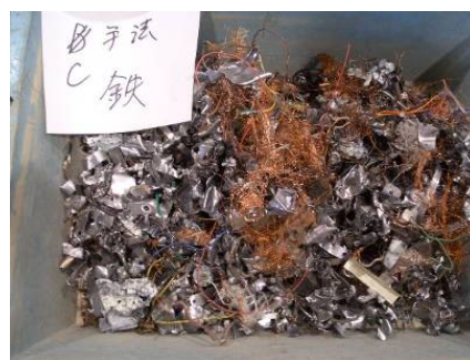
図 3.5.3-2 C 手法で回収・手選別後の鉄 (細い銅線が絡みつき、分別不可能)
