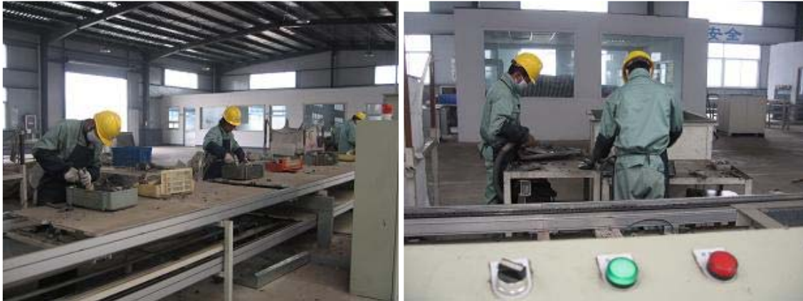
図 2.1.3-8 山東豊緑資源再生有限公司における廃テレビの解体
