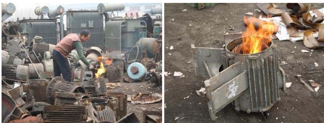
図 2.1.3-2 臨沂の廃金属交易市场における廃ステータの前処理（野焼き）
