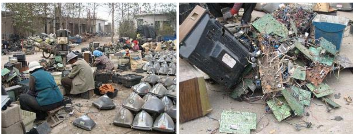
図 2.1.3-12 臨沂の廃テレビリサイクル業者における解体(左)と分離された基板(右)
