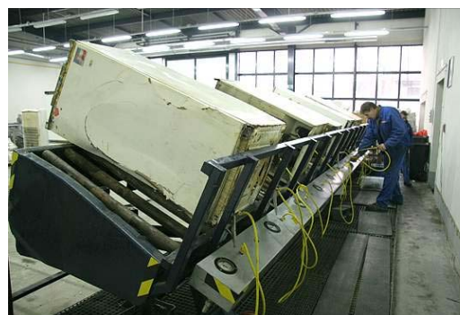
図 2.1.2-22 冷凍機油の回収
