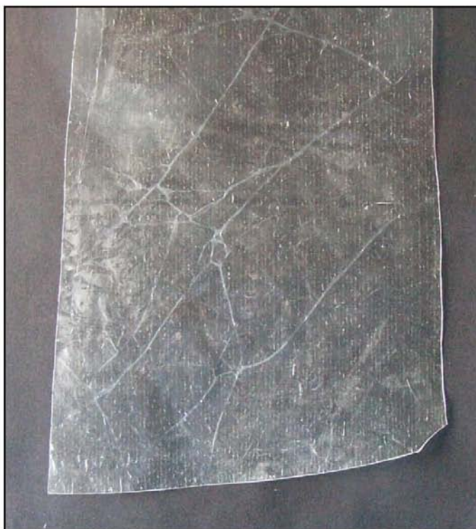
剥離後の中間膜合格サンプル例写真 (No.13, No.14)
