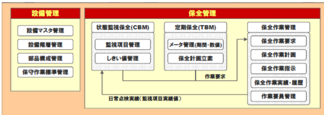
図 3.3.4.3 Oracle eAM における設備保全管理のシステム／サブシステム構成
