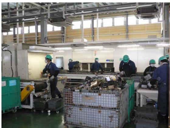
図 2.5.3 家電製品の分解作業
