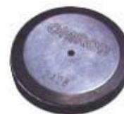
図 2.3.7 樹脂封入した RF タグ
