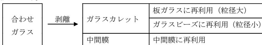
図 5.1.1 本調査研究での実験評価結果
