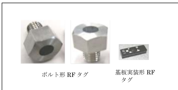
図 1.4.1 ボルト形状 RF タグと基板実装形 RF タグの例 (提供:オムロン(株)、戸田工業(株))
