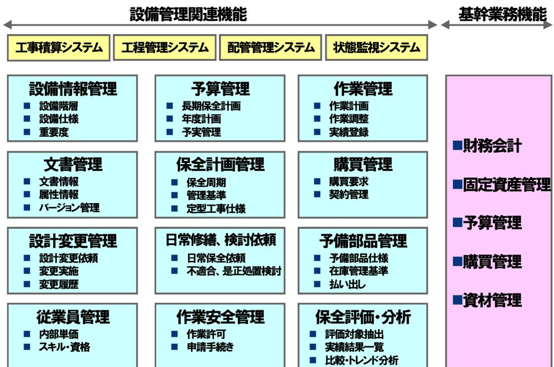
図 1.3.2 プロセス装置を対象とした設備管理システム機能例
