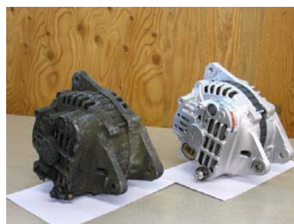
リビルド前のオルタネーター（左）と リビルド後のオルタネーター（右）
