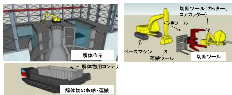
図6. 2. 6 コンクリート建造物の切断技術ロボット化のイメージ
