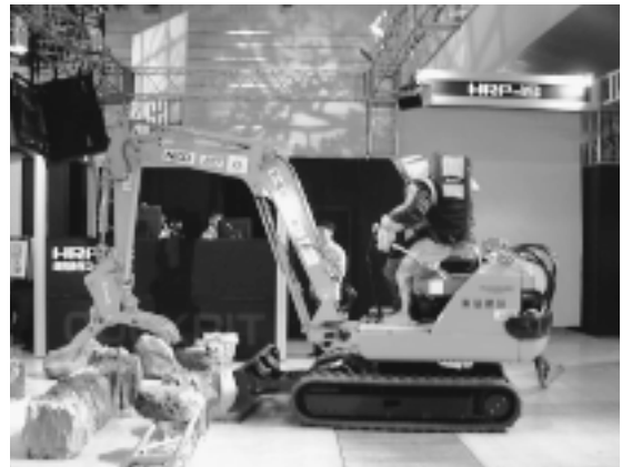
写真 - 6 HRP-1Sのバックフォー操縦デモ
