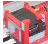
移動コンベア 1台 (加工物を搬送)
