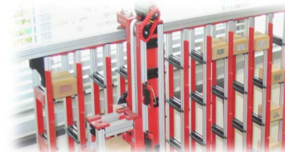
自動倉庫1台 (格納箇所50、出庫及び入庫ステーションを保有)
