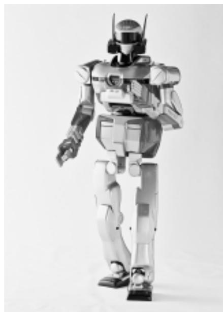
写真 2 新型ロボット(HRP-2)
