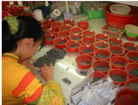
図 3.3.2-18 電子回路部品の手選別 (2005年)
