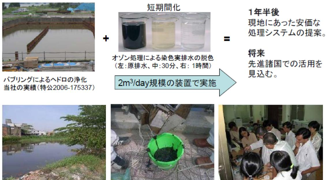
図 3.5.3-15 ベトナムでの浄化実験の状況
