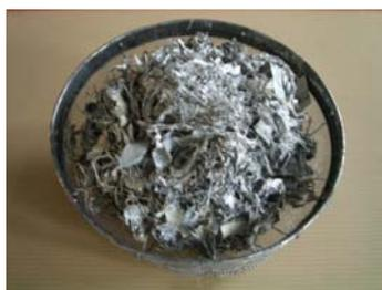
図3. 15 剥離した熱線プリント（酸溶液の浸漬時間 30 分）
