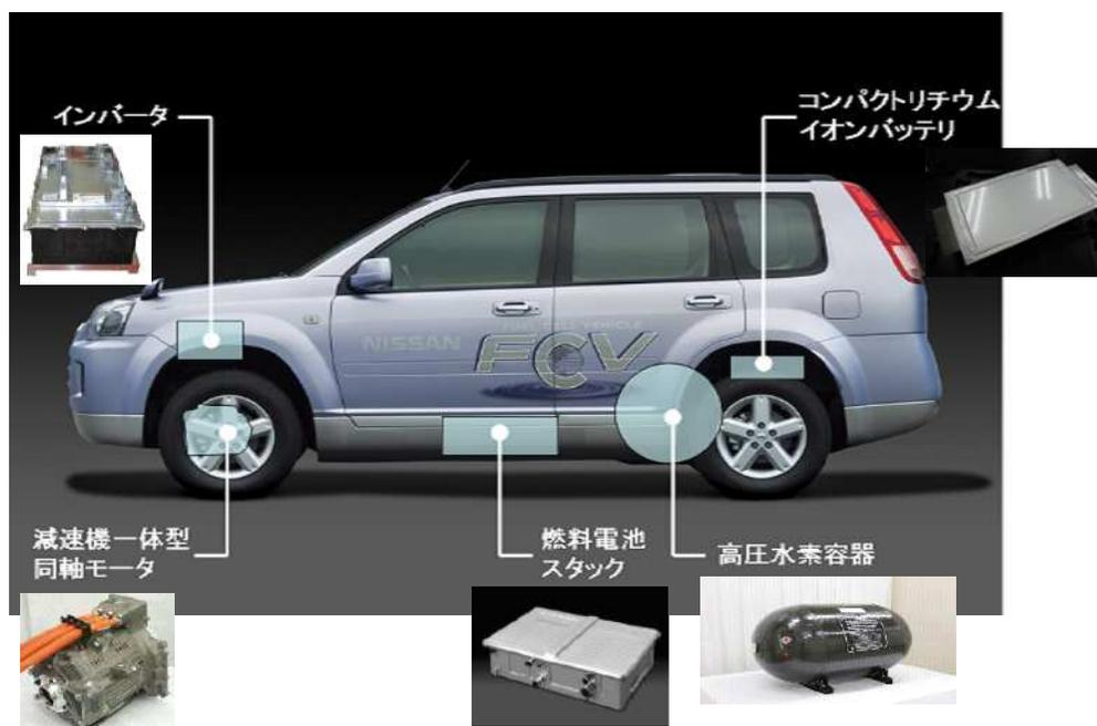
ラミネート型リチウムイオン電池搭載燃料電池車
