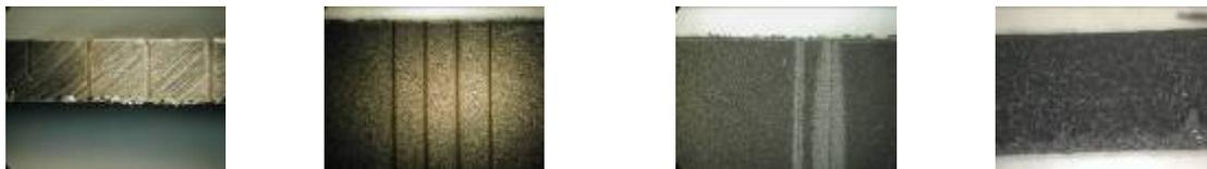
図 3.3.3.(ME30) 切断加工試料の顕微鏡観察結果【水準No.ME 3 0】(照射時間 60 秒後 : 約半分の領域で切断完了 (裏面側に熱荒れ発生)、90 秒後 : 完全切断に至らず (裏面側熱荒れ領域が拡大))
