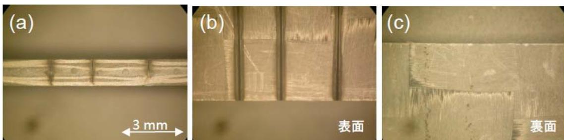
図3.2.2.1 パルス幅100fs、波長800nm、繰り返し1kHz、出力200mWのレーザーを用いた溝加工試料の(a)断面、(b)表面、(c)裏面の光学顕微鏡写真。
