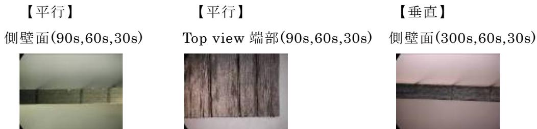
図 3.3.3.(2) 切断加工試料の顕微鏡観察結果【水準No. 2】(照射時間【繊維軸に平行】30秒後：切断完了、【垂直】5分後：完全切断に至らず)
