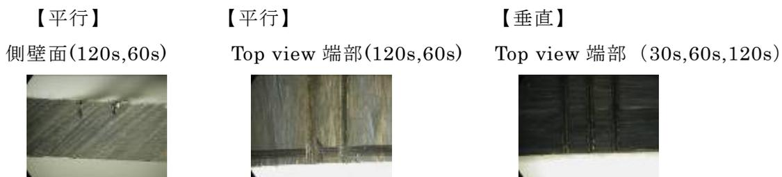
図 3.3.3.(3) 切断加工試料の顕微鏡観察結果【水準No. 3】(照射時間【繊維軸に平行】120秒後：完全切断に至らず、【垂直】120秒後：完全切断に至らず)
