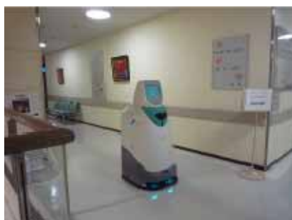
図 3.1.2-6 自律制御による搬送ロボット
