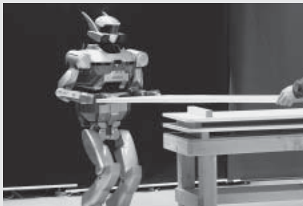
HRP-2のパネル搬送
