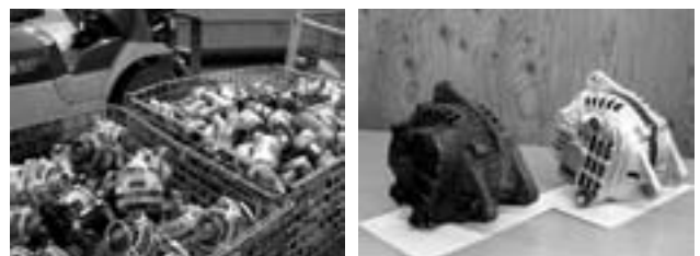
搬入されたコア(使用済み製品) リビルド前のオルタネーター(左)とリビルド後のオルタネーター(右)
